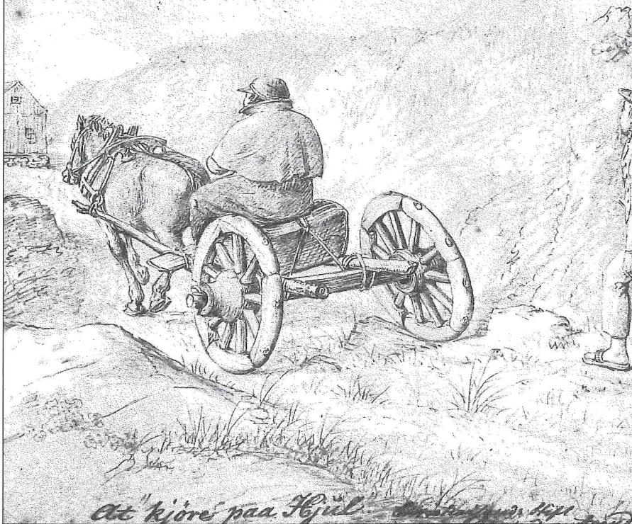
Enkel bondekjerre helt uten fjærer og fast sete. Skisse av Flintoe 1827
