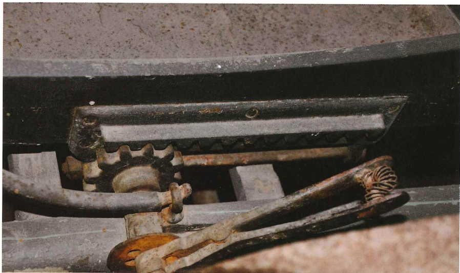
Forskyvning av hele fatingen på Norsengs kjøretøy. Foto BKH.
